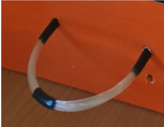
Il fascio di fibre ottiche, visto dall'esterno.
