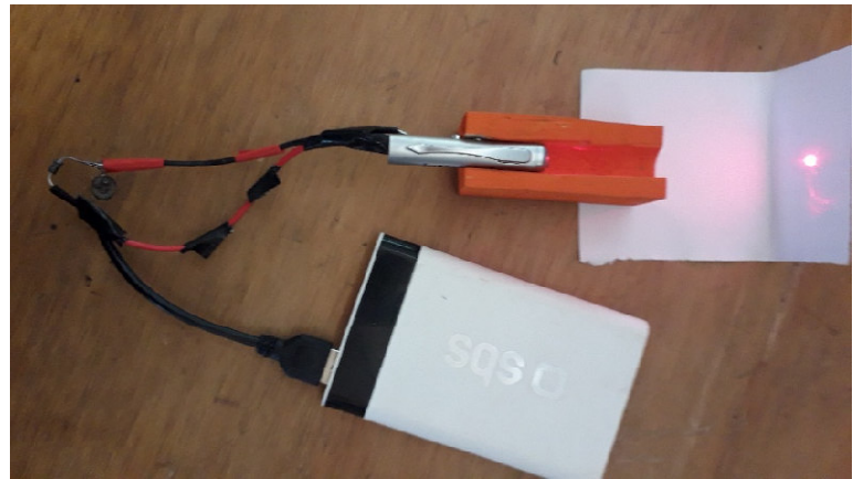
Un puntatore laser modificato (vedi riquadro in basso) è alimentato da un powerbank. Un diodo nel cavo riduce la tensione.
