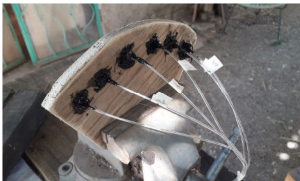
Le fibre ottiche sono incollate nel controller.
