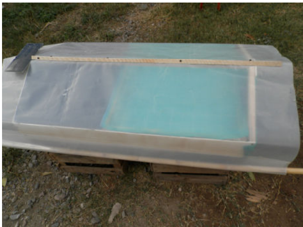
La lámina de plástico para invernaderos con un listón de madera como «frontón» y dos a los lados como peso.
