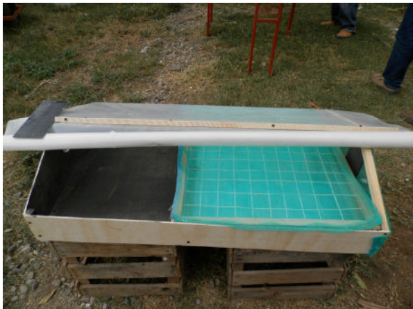
El deshidratador está listo para ser usado: una malla fina cubre la malla gruesa; el ventilador del lado izquierdo sopla aire hacia el deshidratador, que se calienta en el primer 40 % de su recorrido.
