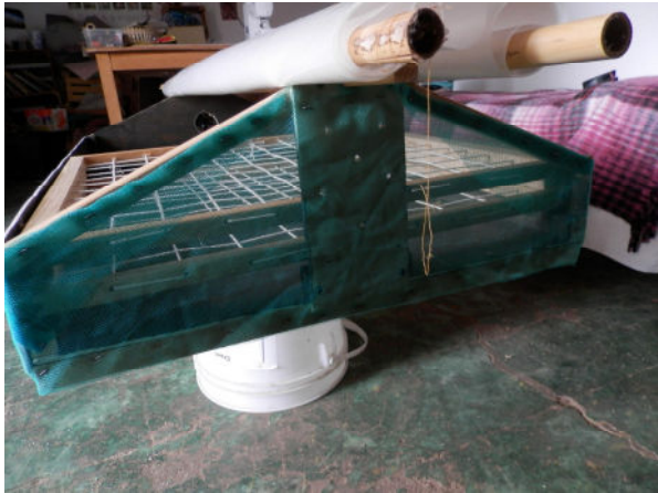
El marco al que se fija el mosquitero y que sostiene el «frontón» del deshidratador.
