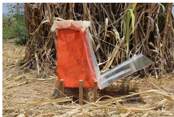
Vista lateral del deshidratador solar terminado.
