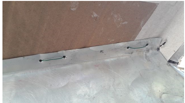
Fija la lámina metálica de manera diagonal dentro de la caja.
