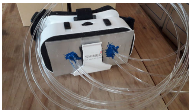
La placa de base (en este caso de aluminio) con fibras ópticas pegadas en las gafas de realidad virtual.
