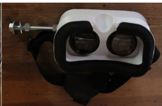
Gafas de realidad virtual con una varilla roscada a la que se pueden conectar los haces de cables de fibra óptica.
