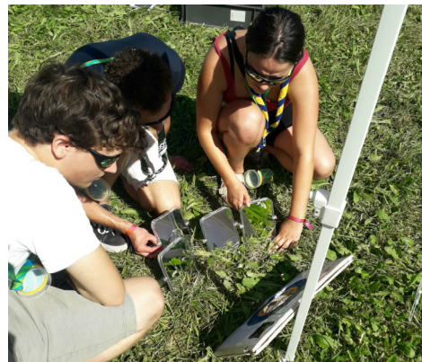
'Solar Dart'-Spiel am Pfadi Folk Festival 2023: Die Spiegel wurden wie bei einem Kraftwerk auf den Boden gestellt und das Sonnenlicht in einem Brennpunkt (dem Temperaturfühler des Thermometers) konzentriert.
