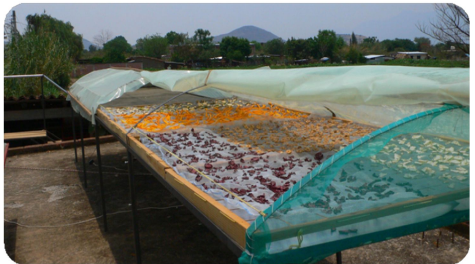
Secador solar “tipo túnel” en una azotea en México (abierto para mostrar la fruta en el interior)
