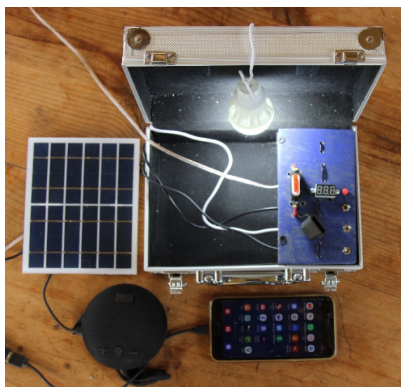
La maleta carga un teléfono móvil y el altavoz al mismo tiempo, mientras funciona la lámpara LED.
