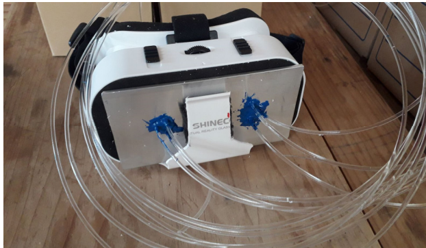
Die Aluplatte mit eingeklebten Glasfasern in der VR-Brille.
