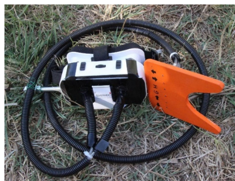
In diesem Bild ist sichtbar, wie die Glasfaserbündel gegen Licht geschützt sind: Von der Brille her zuerst 10cm alle linken bzw. alle rechten Fasern in je einer Hülle, dann alle Fasern zusammen bis kurz vor dem Controller.
