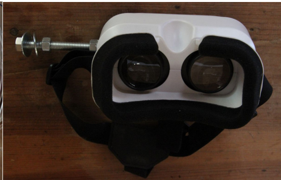
VR-Brille mit Gewindestange, an welcher die Glasfaserbündel festgemacht werden können.
