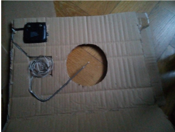
In einer der mittleren Schichten können Temperaturfühler und Kabel in zusätzlichen Aussparungen versteckt werden.
