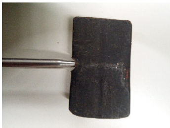
Das fertige Plättchen mit Temperaturfühler
