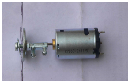
Motor mit gebasteltem Verbindungsstück.
