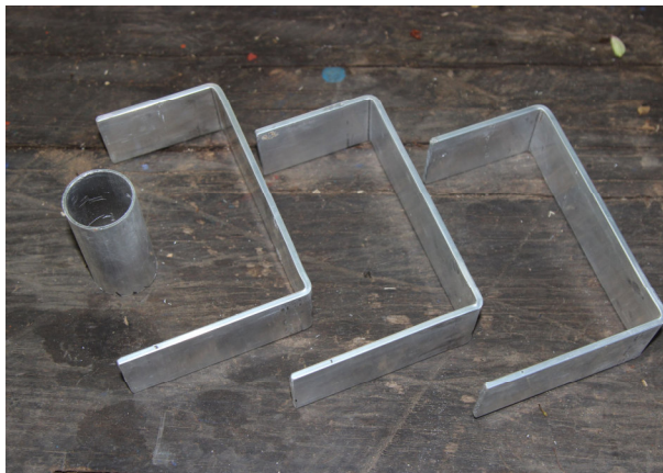
Rohrstück und 3 Aluminiumbügel sind vorbereitet.
