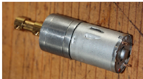
Motor mit professionellem Verbindungsstück.
