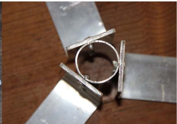
Die Bügel sind mit Nieten am Rohr befestigt.
