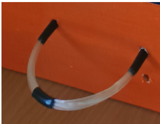
Das Glasfaserbündel, von aussen gesehen.
