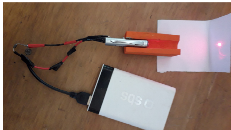
Ein umgebauter Laserpointer (siehe Kasten unten) wird mit einer Powerbank betrieben. Eine Diode im Kabel reduziert die Spannung.
