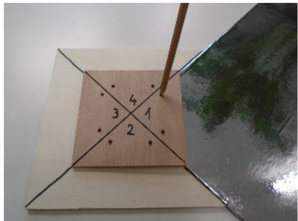
Die Kartonplatte zwischen den beiden Holzplatten, um die Löcher auf dem Karton anzuzeichnen
