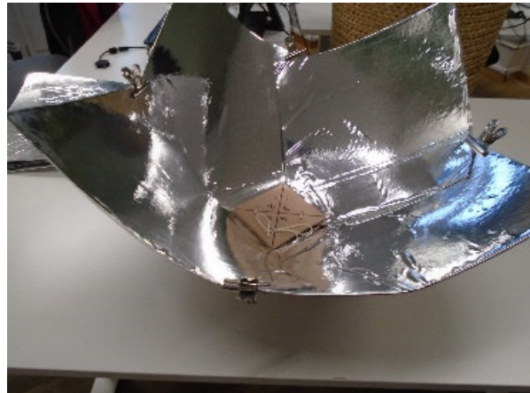
Der fertige Solarkocher
