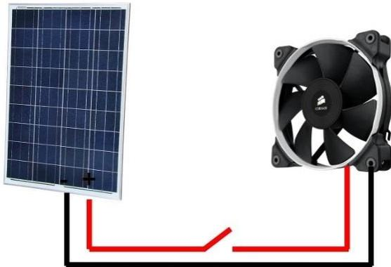
Esquema de las conexiones en el caso del uso directo con un panel solar.
