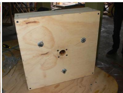
La partie supérieure de la caisse a un trou pour le moteur et trois roulettes de coffre comme soutien pour le disque.
