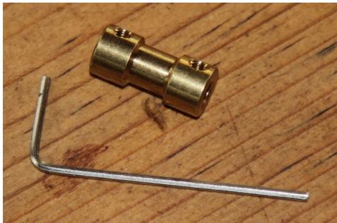
Une pièce de raccordement issue d'un magasin de modélisme.
