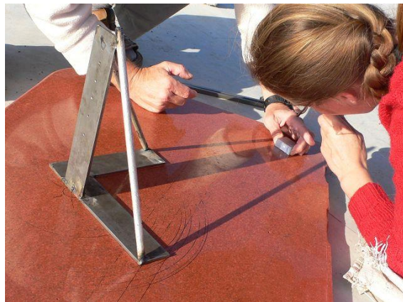
Eine sehr präzise Bestimmung der Ost-West-Linie mit Schattenwurf und Zeichnung auf einer horizontalen, polierten Steinplatte.
