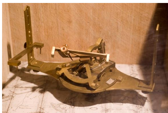
Ein sehr aufwändig gebauter historischer Sonnenkompass. (Bild von Dustin Plunket / Wikipedia)
