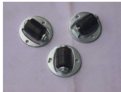
Las ruedas de un coche de juguete sirven de ruedas de apoyo. Pequeñas ruedas de maleta de la ferretería.
