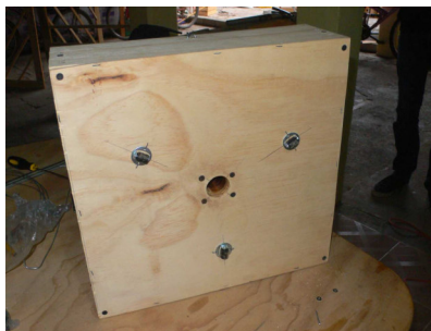
La parte superior de la caja tiene un hueco para el motor y tres ruedas de maleta.
