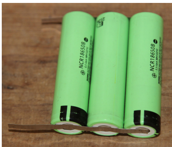
Un "soldador por puntos" puede soldar tiras de níquel a las pilas sin sobrecalentarlas.
