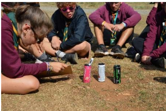
Bild 2: Ausprobieren des Experiments «Farben der Sonne» mit Aludosen unterschiedlicher Farben anstelle der bemalten PET-Flaschen. Die Temperatur des Wassers darin unterscheidet sich auch bei dieser Ausführung merklich.
