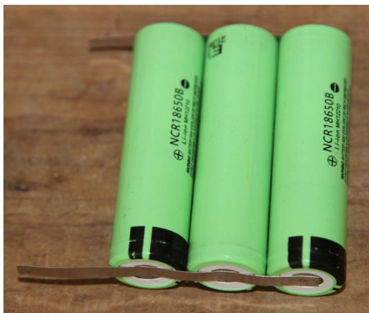
Un « fer souder par points » peut souder des bandes de nickel sur des accumulateurs sans les surchauffer.
