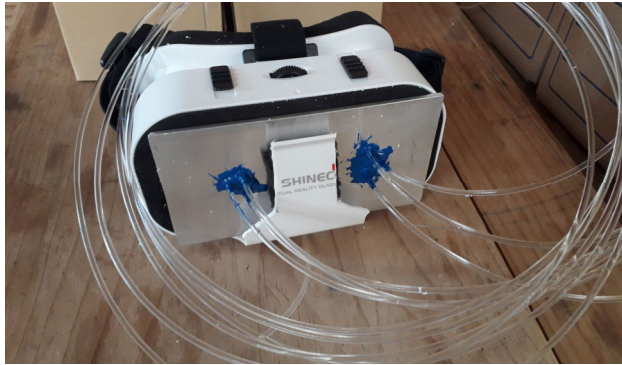
La plaque d'aluminium avec des fibres optiques inséré dans les lunettes de réalité virtuelle.
