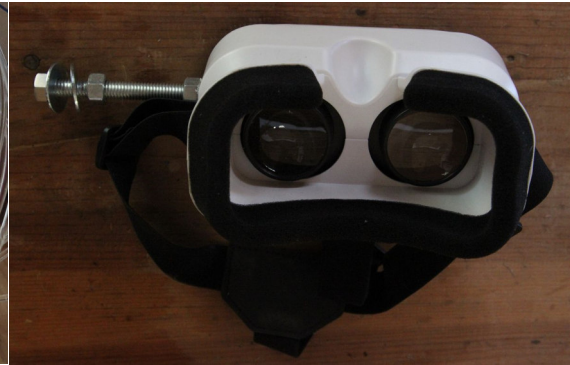
Lunettes de réalité virtuelle avec une tige filetée sur laquelle les faisceaux de fibres optiques peuvent être fixés.
