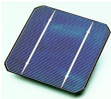
Une cellule solaire avant qu'elle ne soit intégrée dans un panneau solaire.
