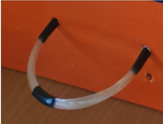
Le faisceau de fibres optiques, vu de l'extérieur.
