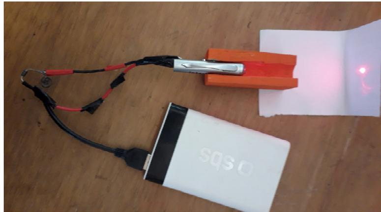
Un pointeur laser transformé (voir encadré ci-dessous) est alimenté par une batterie externe de téléphone portable. Une diode dans le câble réduit la tension.
