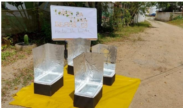
Bild 36: Solar-Öfen mit einem speziellen Design der Reflektoren, Dezember 2022
